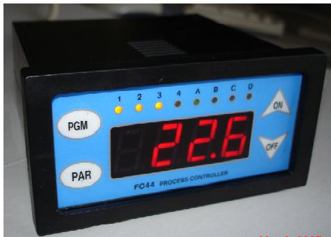
Приложение: за регулиране на температури за шприц-машини, екструдери, пещи, вани, сушилни, бакелитизатори.
